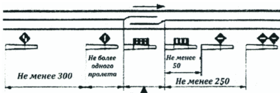
Пролет контактной сети с изолирующим сопряжением или секционным изолятором
